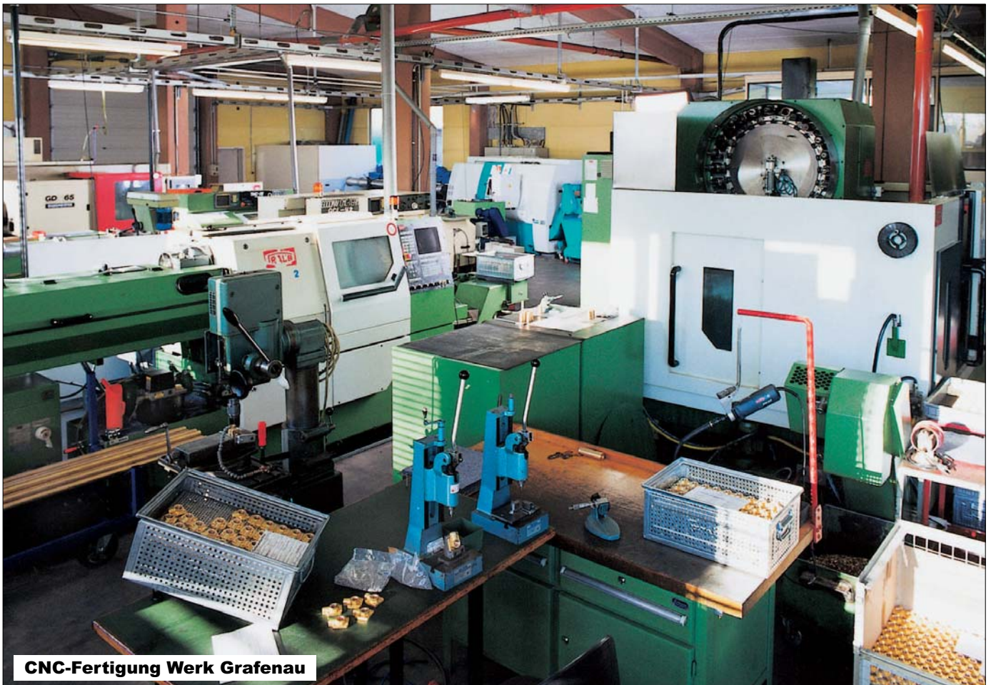
8-Stationen-Schalttrommel-Maschine Werk Grafenau (Roboter lädt, entlädt und prüft die Teile)
